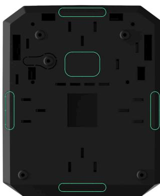
2. Fissare la custodia sulla superficie verticale nel punto di installazione prescelto con le viti in dotazione utilizzando tutti i punti di fissaggio. Uno di essi si trova nella parte perforata sopra il tamper antisabotaggio, serve per attivare il tamper antisabotaggio in caso di qualsiasi tentativo di staccare la custodia dell'hub.
