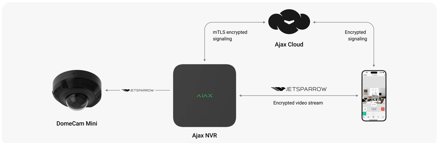
DomeCam Mini può funzionare senza Ajax NVR, salvando l'archivio sulla scheda SD (se installata)
