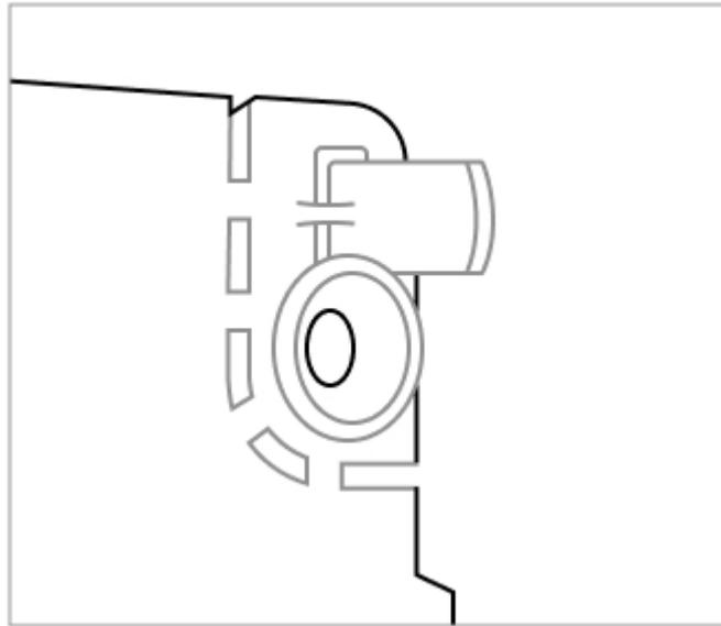
5. Far scorrere KeyPad Plus sul pannello di montaggio e stringere la vite di montaggio sul fondo del corpo. La vite è necessaria per un fissaggio più affidabile e per proteggere la tastiera da un rapido smontaggio.
