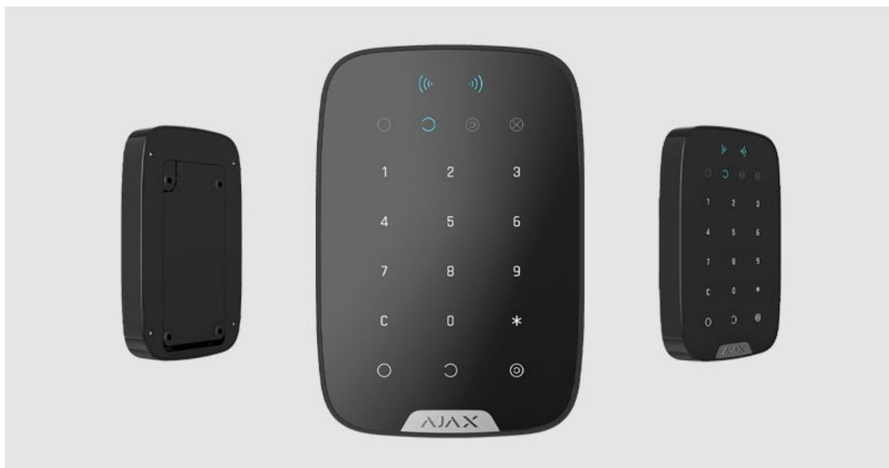
**KeyPad Plus** è una tastiera touch wireless da interno per la gestione del sistema di sicurezza Ajax con carte e portachiavi contactless protetti. Supporta “l’allarme silenzioso” quando si inserisce il codice coercizione. Indica la modalità di sicurezza attuale con una luce LED.
