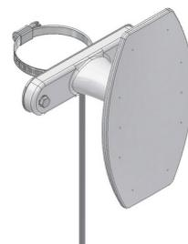
Fissare il kit staffa all'antenna tramite apposita viteria
