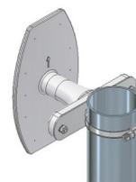
Stringere la fascetta sul palo facendo attenzione ad installare l'antenna con la freccia rivolta verso l'alto e posizionata a qualche cm dall'estremo più alto del palo
