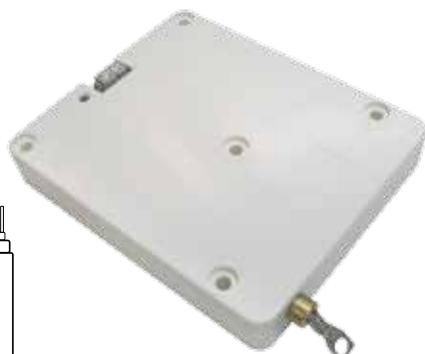
Sensore a filo per tapparelle, boccola di scorrimento cordina in ottone smussato, 5 punti di fissaggio per installazione facilitata. Struttura particolarmente robusta per massima affidabilità nel tempo. Connessione a morsetto 4 poli; necessita scheda di analisi per sensori veloci.
