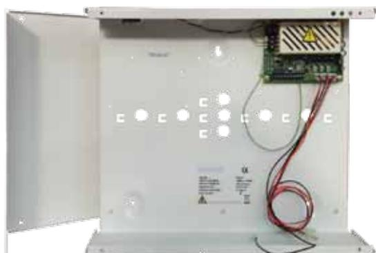
Serie di stazioni di alimentazione caricabatterie per sistemi antintrusione 13,8Vcc conformi con la normativa EN50131-6. Disponibili in 2 gradi di prestazione. Tecnologia switching, segnalazione LED di presenza rete, standby e guasto fusibile. Su tutti i modelli è presente la protezione tamper 24h antiapertura a microswitch. Possibilità di alloggiare e monitorare separatamente fino a 3 batterie 12V 7,2Ah o 2 batterie 12V 18Ah.
