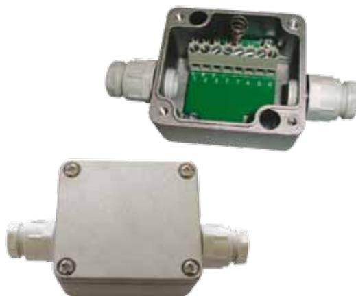
Scatola di giunzione in alluminio sabbato 6 poli indipendenti + 2 poli di tamper; da esterno. Viti di fissaggio protette, viti coperchio imperdibili, 2 fori per pressatubi tipo PG9.
