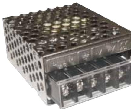
Alimentatore caricabatteria switching 13,8Vcc 2,8A. Morsetti di collegamento uscite e cavi faston per collegamento batteria. Trimmer di regolazione della tensione di uscita. Protezione contro il cortocircuito.
