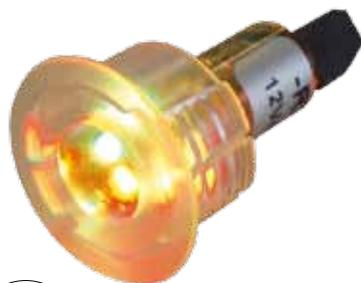
Ripetitore ottico con LED ad alta intensità per installazione ad incasso in interni o esterni riparati. Ottima visibilità anche in condizioni di luce diurna. Alimentazione 12Vcc con basso assorbimento luce fissa. Connessione a morsetto 3 poli. Disponibile in 6 versioni: rosso, giallo, verde, blu, bianco e bicolore rosso-verde. Contenitore in ABS trasparente.
