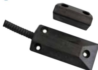
Contatto magnetico di dimensioni ridotte in materiale plastico ultraresistente caricato vetro per porte basculanti; omologato IMQ con la norma europea EN50131-2-6 grado 2 classe ambientale IV. Contatto N.C. con anta chiusa. Il contatto si adatta all'installazione al suolo grazie ad un profilo di soli 13mm. Contatto chiuso con magnete ad una distanza non superiore a 25mm.
