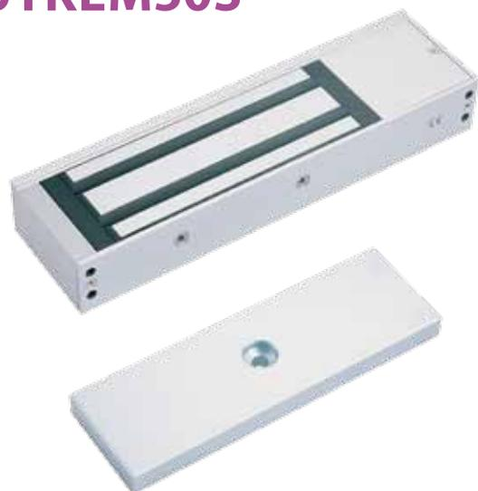
Chiusura elettromagnetica con forza di ritenuta di oltre 530Kg. Alimentazione 12/24Vcc. Installazione in superficie. Adatto alla chiusura di porte di grandi dimensioni o di serramenti di passaggio e ad alta sicurezza. Disponibile anche nella versione con relè di scambio per segnalazione stato porta.
