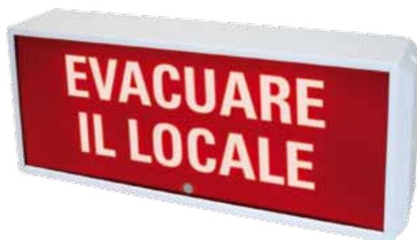
Targa ottica di segnalazione autoalimentata con led ad elevata resa luminosa. Alimentazione 12/24Vcc. Batteria integrata 6V1,2Ah per funzionamento autonomo. Illuminazione fissa o lampeggiante selezionabile. Contenitore in profilo di alluminio verniciato e schermi intercambiabili. Set di 5 scritte intercambiabili incluso (UTKLAMPSET1).
