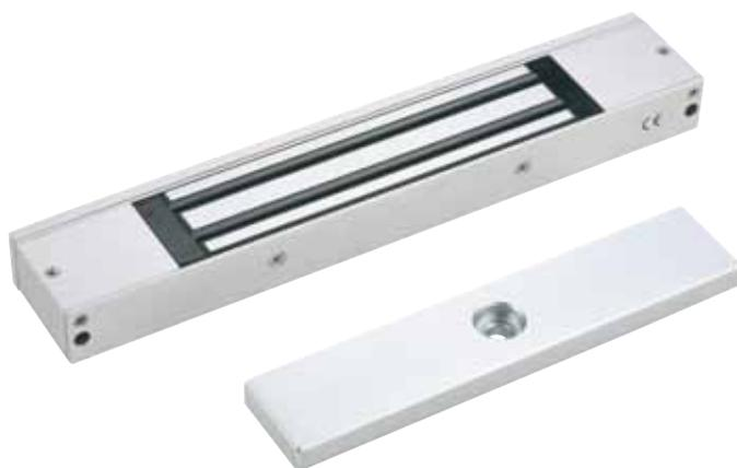
Chiusura elettromagnetica con forza di ritenuta 180Kg. Alimentazione 12/24Vcc. Installazione ad incasso sul serramento. Adatto alla chiusura di porte di piccole dimensioni o di serramenti di passaggio e non ad alta sicurezza.
