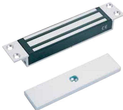
Chiusura elettromagnetica con forza di ritenuta 180Kg. Alimentazione 12/24Vcc. Installazione in superficie. Adatto alla chiusura di porte di piccole dimensioni o di serramenti di passaggio e non ad alta sicurezza.
