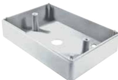
Scatola per il fissaggio a muro dei pulsanti e componenti della serie UTKAPX. Basso profilo. Corpo in materiale plastico di colore bianco. Adatta all'inserimento di moduli analogici di indirizzamento. Per colori differenti sostituire la W con R=rosso / G=giallo / V=verde.
