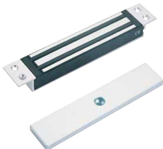
Chiusura elettromagnetica con forza di ritenuta 300Kg. Alimentazione 12/24Vcc. Installazione ad incasso sul serramento. Adatto alla chiusura di porte di dimensioni standard o di serramenti di passaggio e ad alta sicurezza. Relè di scambio per segnalazione stato porta.
