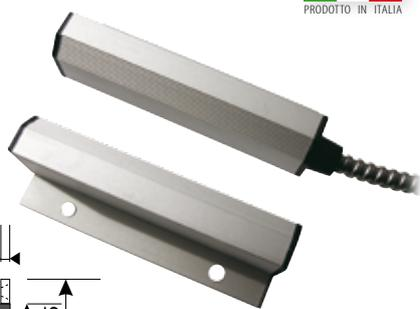
Contatto magnetico per superficie di grande portata conforme con la normativa europea EN50131-2-6 grado 2 classe ambientale IV. Contatto N.C. con anta chiusa. Contenitore in alluminio di elevata resistenza agli urti, per l'installazione su porte e serramenti in materiali ferromagnetici e non. Collegamento con cavo a 4 fili di lunghezza 100 cm protetto da guaina in acciaio.
