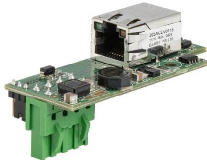
In alternativa all'alimentazione diretta a 13,8V<sub>CC</sub> è possibile alimentare tutti i moduli presenti nella singola colonna attraverso IP-DOORWAY. IP-DOORWAY è un convertitore di linea RS485 – Ethernet progettato espressamente per essere inserito, oltre che nel prodotto MICRO-RAY, anche su tutti i dispositivi digitali CIAS.
