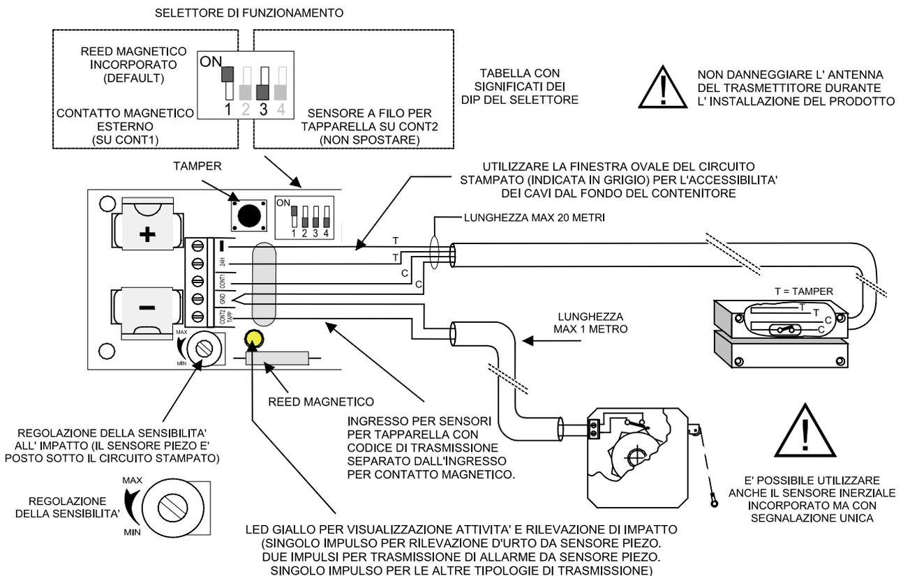
**Nota:** nel trasmettitore mod. VOLANSC qualora venisse spostato il dip n°3 su ON si perderebbe la funzionalità del rivelatore piezo ad esclusivo vantaggio della gestione di un contatto magnetico esterno su CONT2.
