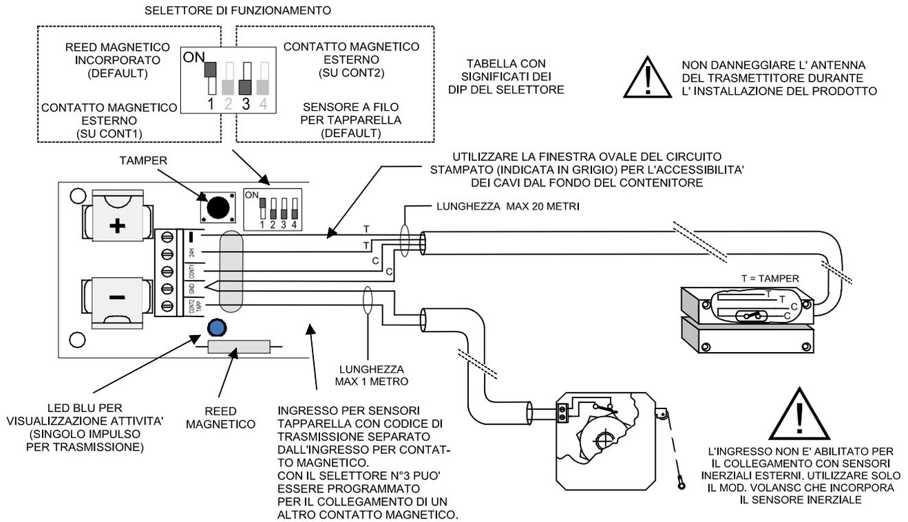
Vista della scheda del trasmettitore VOLANSC, disposizione interna e collegamenti generali, vedere i singoli disegni di dettaglio.
