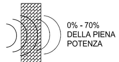
CEMENTO ARMATO O LAMIERA E INTONACO
