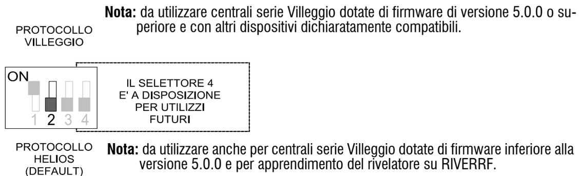
**ATTENZIONE:** la posizione errata del selettore non consentirà una trasmissione intelligibile con la centrale compatibile.
