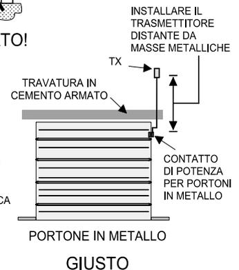
Attenuazione del segnale radio da parte di alcuni materiali tipici da costruzione.
