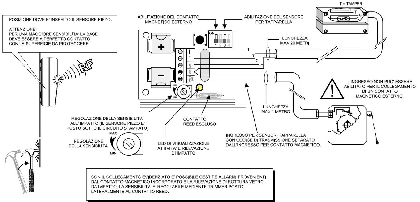
**Nota:** non è possibile utilizzare il trasmettitore VOLANSC con un secondo contatto magnetico esterno collegato al morsetto CONT2 (il dip n°3 deve essere sempre in posizione OFF) pena la perdita della gestione del rivelatore piezo interno.
