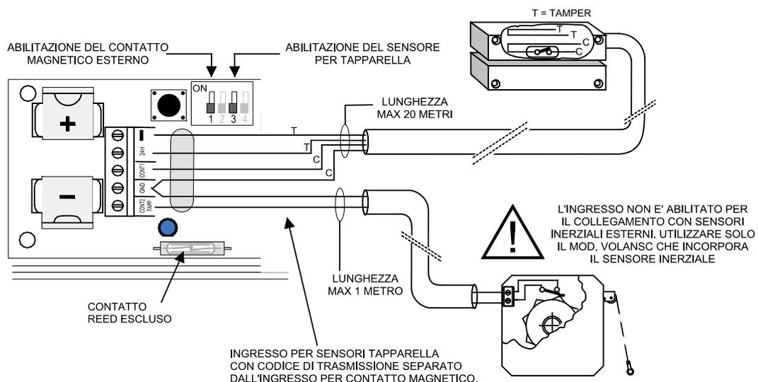
**Nota:** al fine di garantire la certificazione del prodotto è necessario realizzare i cablaggi delle linee di protezione Tamper del contatto magnetico esterno e del sensore per tapparella al morsetto apposito del trasmettitore.
