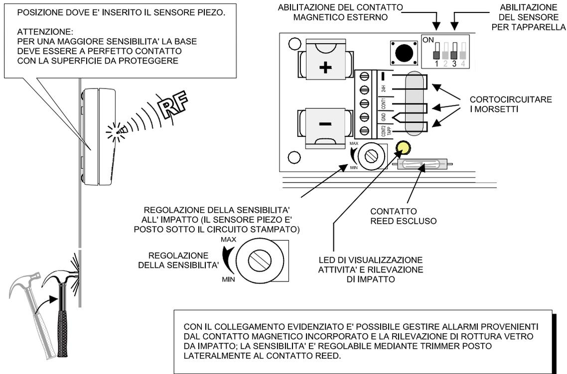
**Nota:** al fine di garantire la certificazione del prodotto è necessario realizzare i cablaggi delle linee di protezione Tamper del contatto magnetico esterno e del sensore per tapparella al morsetto apposito del trasmettitore.
