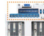
Tutti i componenti necessari alla regolazione del sensore e le impostazioni sono di colore blu.
