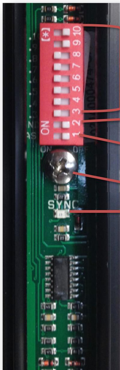
**BEAM:** spostare in ON i DIPSWITCH fino al numero corrispondente di espansioni aggiunte alla barriera. Il mancato spostamento del DIPSWITCH in ON escluderà il funzionamento del relativo fascio
