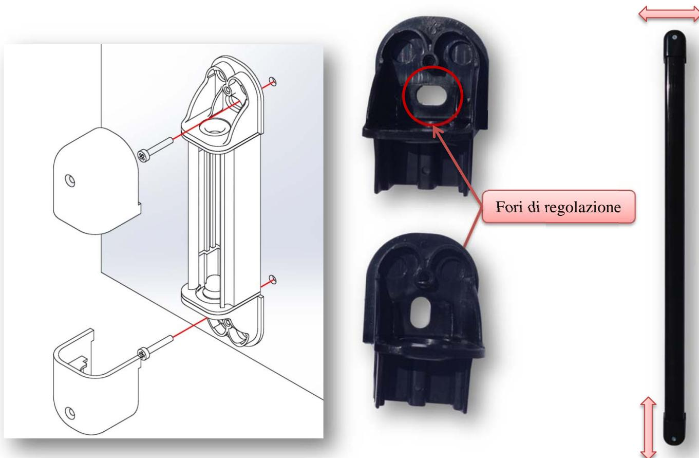
10. Al termine del processo di installazione e allineamento, chiudere il coperchio con la vite in dotazione.
