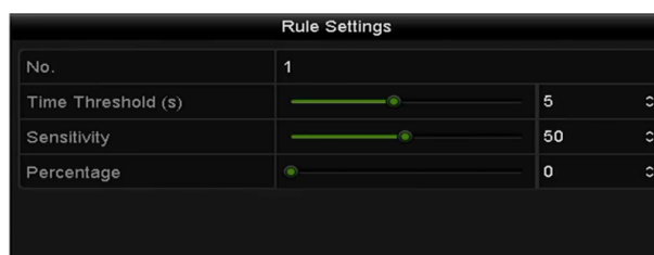
Figura 10–8 Impostazione delle regole di rilevamento intrusione.
