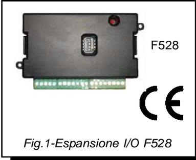
Il modulo di espansione di ingressi e uscite F528 consente di aggiungere 8 zone di ingresso, 2 uscite relè e 2 uscite open collector, alle centrali bus mod. UNICA PRO, UNICA COM, UNICA ESS, UNICA LIGHT e DB9000; il tutto impostabile in fase di programmazione della centrale. La scheda elettronica del modulo F528 può essere alloggiata direttamente all'interno del box della centrale UNICA PRO o dell'alimentatore supplementare F560 con l'ausilio di 4 distanziali.
