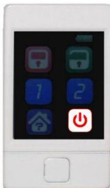
Radiocomando bidirezionale, display a colori TOUCH SCREEN da 1,77", rolling code, risposta visualizzata su display, richiesta stato, segnalazione visiva porte aperte e anomalia, abbinabile alle centrali Select DUAL BAND e serie UNICA, batteria al litio-polimero ricaricabile tramite presa micro USB.
