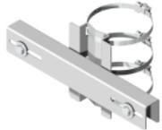
**staffa in acciaio INOX con collari e bulloneria INOX, barra di fissaggio apparati da 300 mm, interasse di fissaggio 156 ÷ 280 mm**
