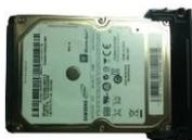
② Assicurarsi che La superficie del metallo HDD è rivolta verso l'alto e quindi mettere l'HDD nella staffa orizzontalmente. Dopo che l'HDD è nella posizione corretta, le colonne delle due parti consentono di bloccare i fori.
