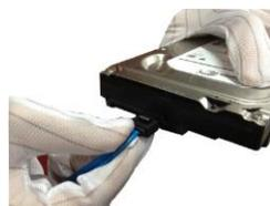
③ Collegare l'altra estremità del cavo dati HDD e il cavo di alimentazione all'HDD.
