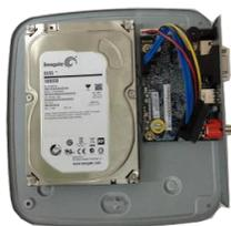
② Posizionare l'HDD in base ai quattro fori sul fondo.
