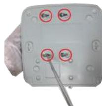
③ Capovolgere il dispositivo e quindi fissare saldamente le viti.
