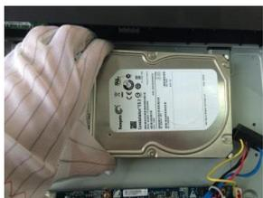
④ Posizionare l'HDD in corrispondenza dei quattro fori sulla parte inferiore del telaio metallico
